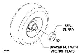
FIGURE 10 CASTER WHEEL ASSEMBLY
